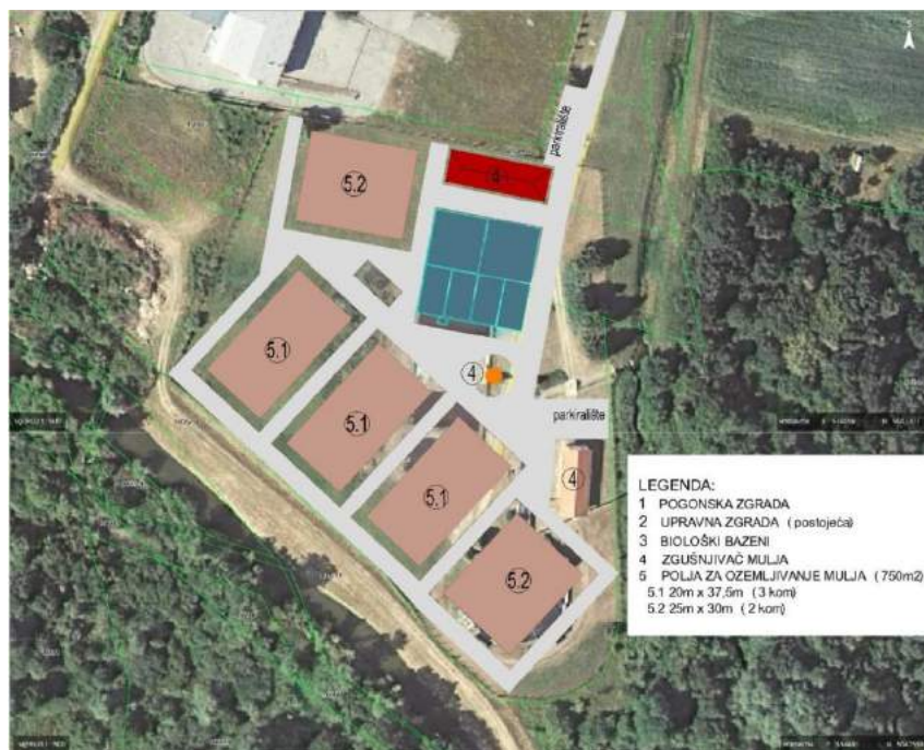
Slika 1.28 Situacijski prikaz smještanja UPOV-a Garešnica-Hercegovac u prostor
